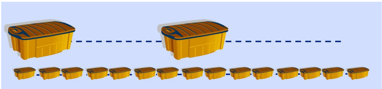
Abbildung 5: Viele kleine Behälter lassen Bedarfe und Material besser fließen als wenige große
