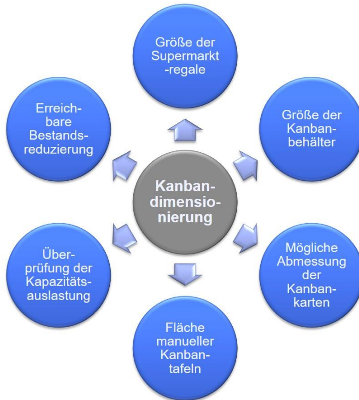
Abbildung 9: Die Dimensionierung der Kanbanregelkreise ist die Grundlage für die gesamte Auslegung der Kanban-Infrastruktur
