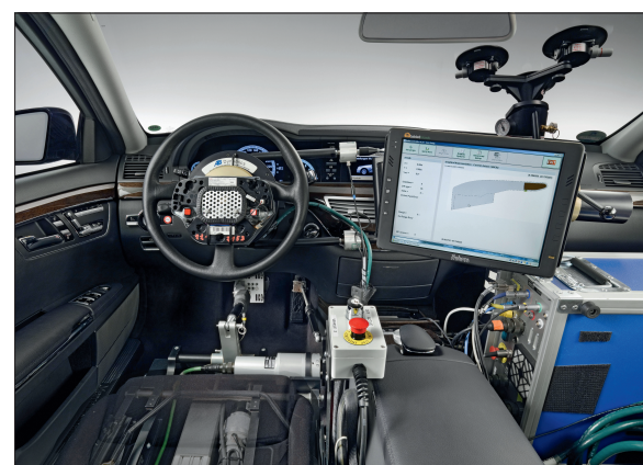
Fahrroboter: Wenn es auf exakt reproduzierbare Ergebnisse ankommt, lassen Entwicklungsingenieure gern Roboter und Rechner ans Steuer.
